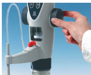
Easy titration via handwheel
